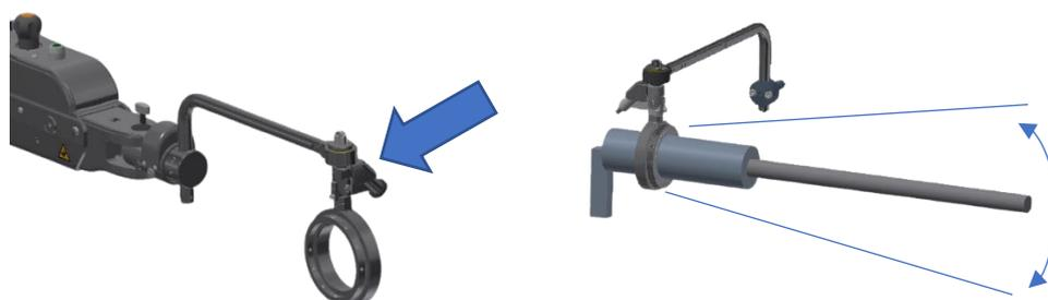
El equilibrador dinámico, dota al sistema de flotabilidad angular, lo cual permite absorber ciertas desalineaciones entre el eje transversal de la herramienta y la tuerca o tornillo a trabajar.
