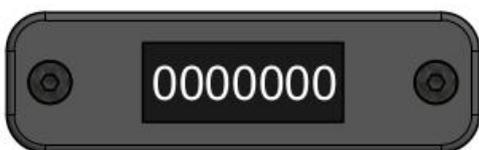
Lorsque la machine est allumé elle montre la chiffre total de taraudages.
