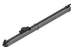
Guide pour le déplacement horizontal du bras. Plusieurs tronçons peuvent se joindre à partir d'un tronçon de base de 2 m. Il peut être à poser sur l'établi, à fixer sur le mur, le plafond, ou sur des piliers de différentes hauteurs au choix. La position horizontale peut être bloquée à n'importe quel point.
