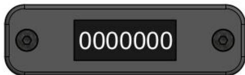
Lorsque la machine est allumée elle montre le chiffre total de taraudages.
