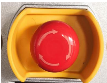
Fig. 8.3 Parada de emergencia
