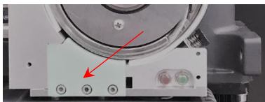
Fig. 21.28 Coloque la pieza de plástico y ponga los anillos de retención.
