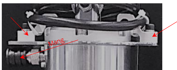
Fig. 21.44 Afloje y retire las abrazaderas de cables (flechas rojas). Empuje el manguito hacia atrás y sáquelo.
