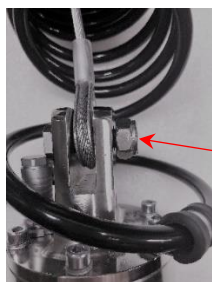
Fig. 21.45 La unión (flecha roja) debe aflojarse y la cuerda debe separarse de la unidad de control.
