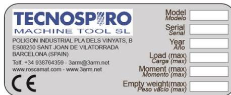
Si vous avez acquis l'accessoire en tant qu'élément d'un ensemble, par exemple, un bras articulé 3arm® avec un support de garde-corps, l'étiquette d'identification correspondante indiquera les caractéristiques suivantes.
